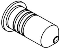
**A450** ist eine Hochleistungsdüse die mit einem Pulsed Atmospheric Arc (PAA®) Plasma Generator (PG31) und gepulstem Hochspannungsnetzteil (PS2000) betrieben wird.
